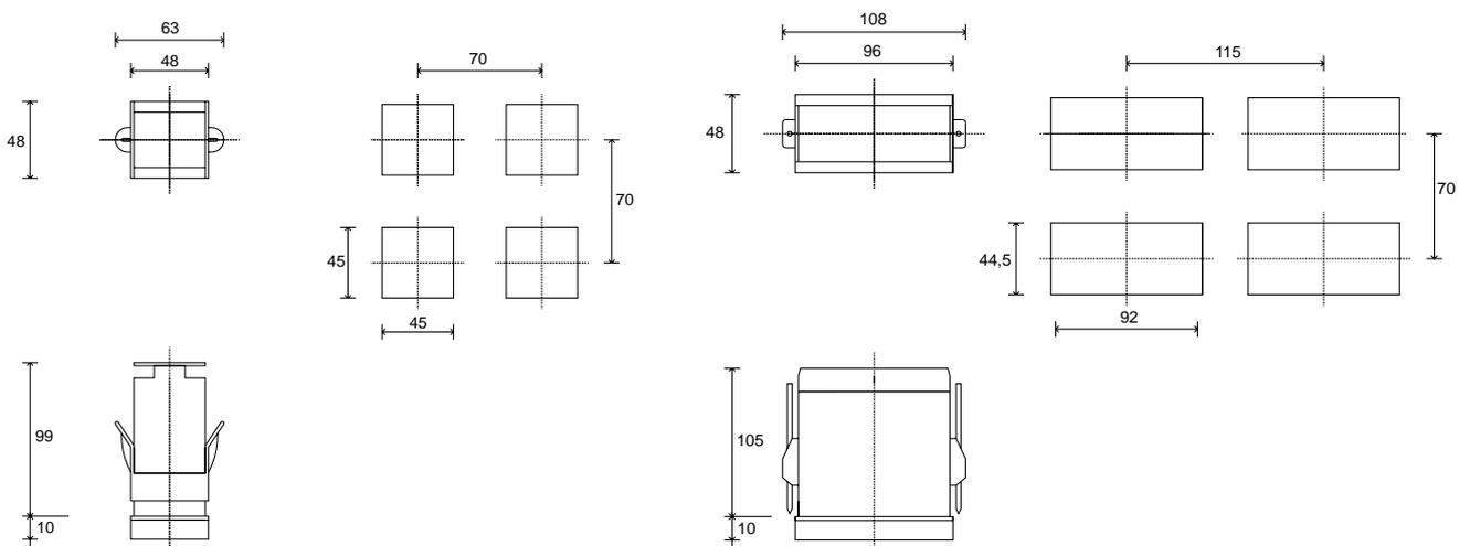
尺寸：48X48-96X48mm (1/16DIN-1/8DIN) 深度：99mm-105mm
