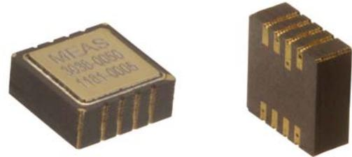
**3038** 是一款密封型表面贴装加速度计，适用高性能应用。该加速度计结合了空气阻尼的压阻式MEMS传感元件，能提供优越的长期稳定性。3038型具有微伏输出信号和机械超载停止的功能，可以提供超过10000g负载的震动保护。
