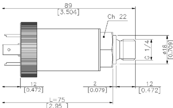
尺寸： 因为多了自动归零与量程设置电路板，TKDA增长5mm(0.197英寸)，所以TK数据表中的尺寸“L”变为75mm(2.95英寸)。
